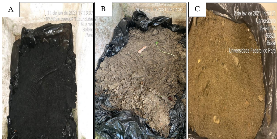
Figura 17- Mudança visual durante o processo de secagem. A) Material no dia da coleta; B) 17 dias após a coleta; C) 22 dias após a coleta.
