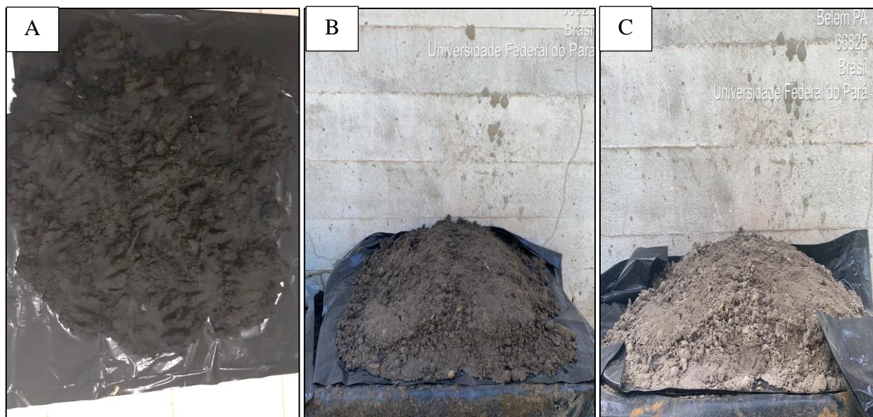
Figura 14- Mudança visual do material durante o processo de secagem; A) Aspecto do material no dia da coleta; B) Mudança após 6 dias de secagem; C) Mudança após 8 dias de secagem.
