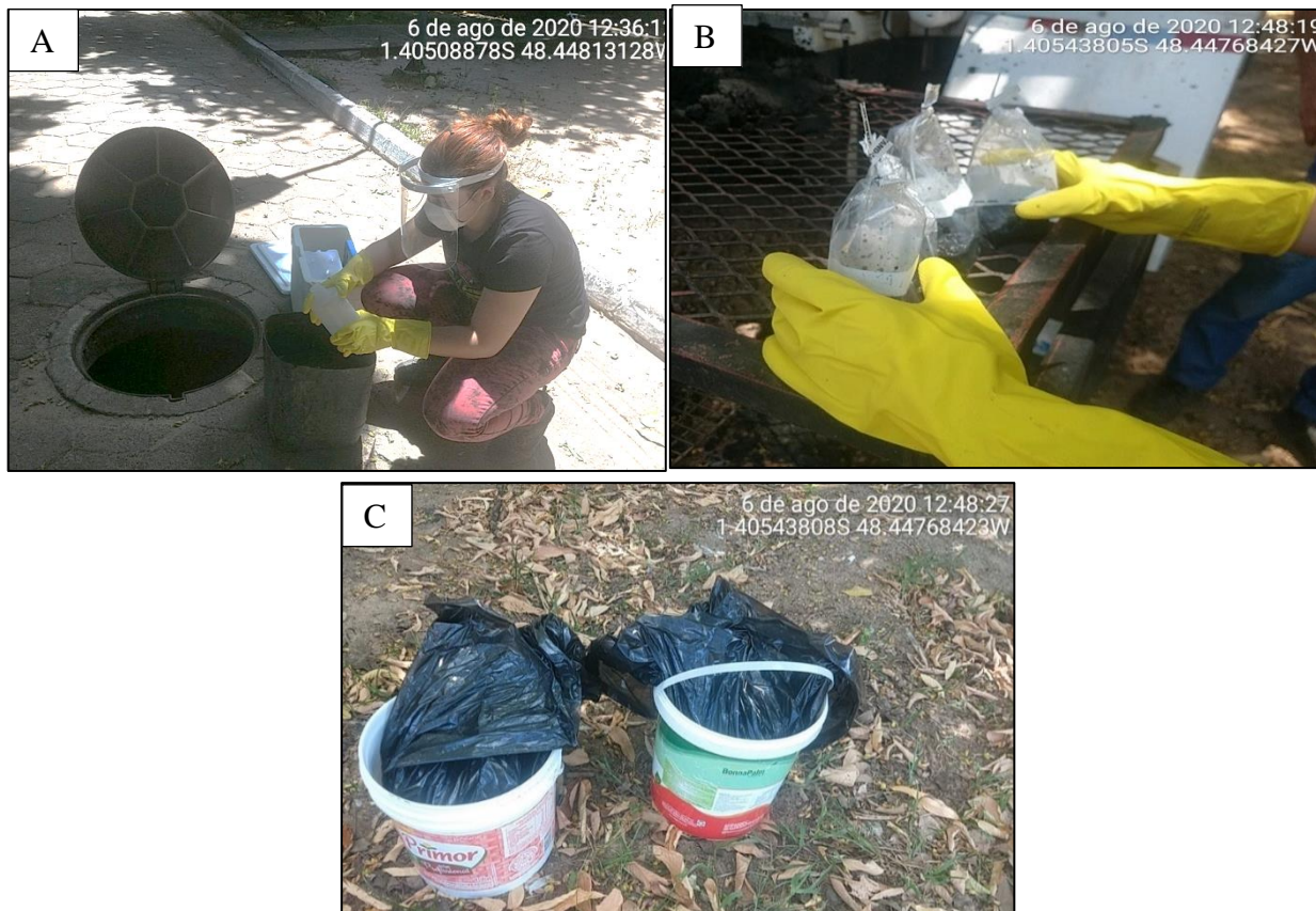
Figura 12- A) Coleta do material líquido; B) Coleta do material sólido (análise química); C) Coleta do material sólido (análises físicas).
