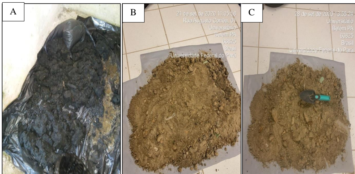
Figura 19- Mudança visual durante o processo de secagem. A) Material no dia da coleta; B) 28 dias após a coleta; C) 35 dias após a coleta.
