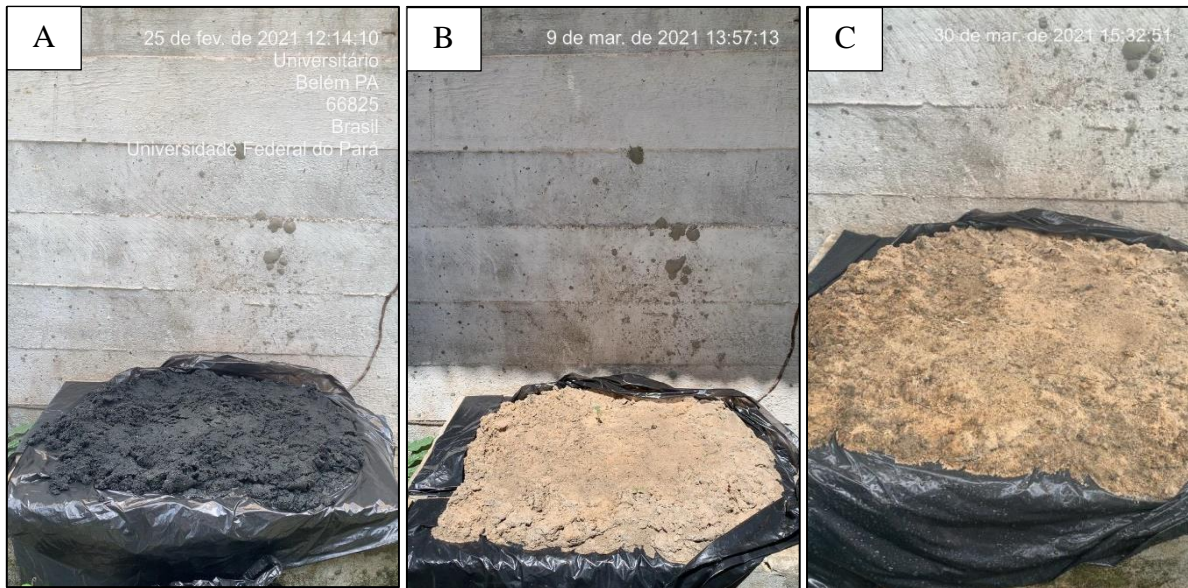
Figura 21- Mudança visual durante o processo de secagem. A) Material no dia da coleta; B) 15 dias após a coleta; C) 36 dias após a coleta.
